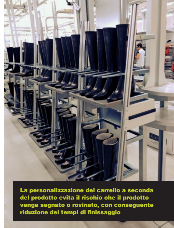
Dynamic permette di passare dalla movimentazione delle scarpe a quella degli stivali regolando altezza e accessori
