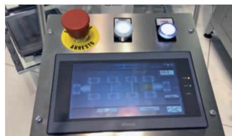
Pannello touch per la configurazione della manovia
