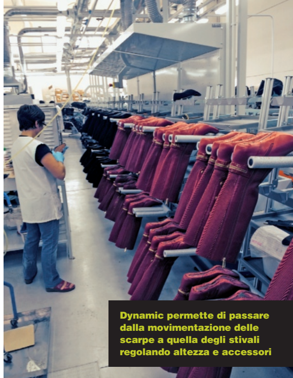
La personalizzazione del carrello a seconda del prodotto evita il rischio che il prodotto venga segnato o rovinato, con conseguente riduzione dei tempi di finissaggio
